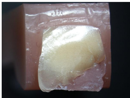
Figura 9 Fotografía con microscopio a 10X de espécimen New Stetic (Duratone-n®) en donde se observa la caracterización del tipo de falla combinado
