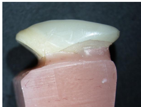
Figura 8 Fotografía con microscopio a 10X de espécimen New Stetic (Duratone-n®) en donde se aprecia el patrón de fractura luego de realizar la tensión con la máquina Instron
