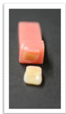
Figura 6 Falla combinada de espécimen
