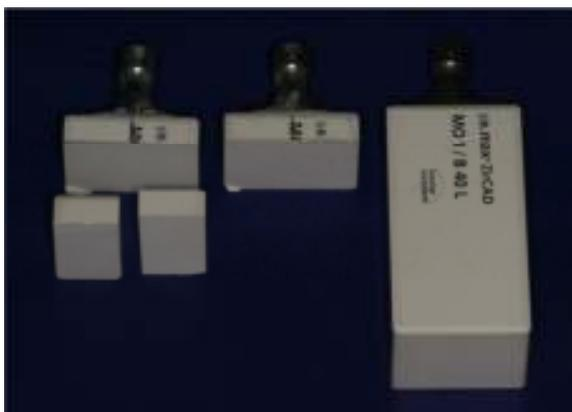
**Figura 9-Imagen del corte de bloques de Dióxido de zirconio presinterizados.**
