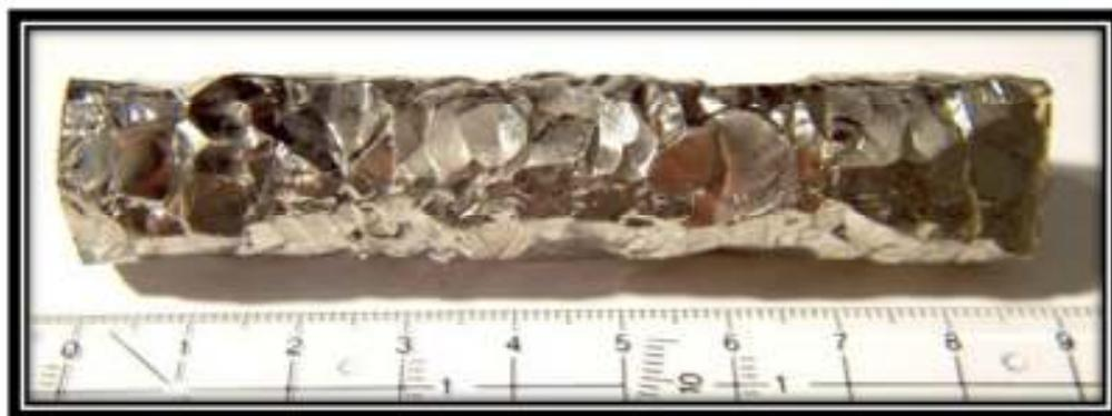
**Figura1- Imagen del Zirconio. Metal duro, de color blanco grisáceo, brillante y muy resistente a la corrosión<sup>85</sup>.**
