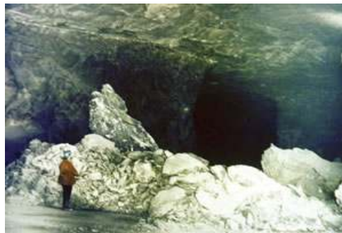
Figura 1. Derrumbe grande de rocas en una mina subterránea de piedra caliza.
