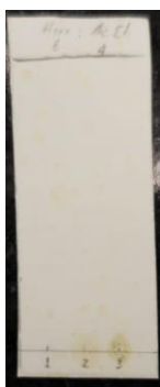
Figura 7. Resultados del revelado de la cromatografía en capa fina (TLC) (placa de la Figura 12) obtenidos con la muestra extraída de propóleos (1) en comparación con dos muestras de propóleos sin extracción previa (2) y (3). Revelado con tricloruro férrico para determinar la presencia de fenoles. Se observa la ausencia de fenoles en la placa, ya que se agregó el revelador en exceso (puntos rojos en la placa).
