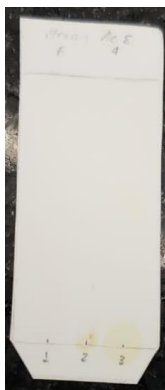
Figura 6. Resultados del revelado de la cromatografía en capa fina (TLC) (placa de la Figura 12) obtenidos con la muestra extraída de propóleos (1) en comparación con dos muestras de propóleos sin extracción previa (2) y (3). Revelado con DPPH para determinar la presencia de antioxidantes. Se observa la ausencia de sustancias antioxidantes.
