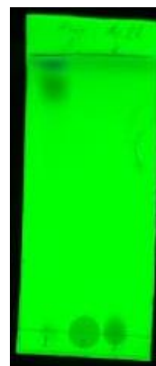
Figura 5. Resultados de cromatografía en capa fina (TLC) obtenidos con la muestra extraída de propóleos (1) en comparación con dos muestras de propóleos sin extracción previa (2) y (3). Fase Móvil= Hexano: Acetato de Etilo (6:4). Placa observada a través de transiluminador UV, \lambda=366 nm.
