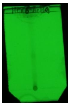
Figura 9. Resultados de cromatografía en capa fina (TLC) obtenidos con la muestra extraída de propóleos dos (extracción con co-solvente etanol). Fase Móvil= Hexano: Acetato de Etilo (6:4). Placa observada a través de transiluminador UV, \lambda=366 nm.
