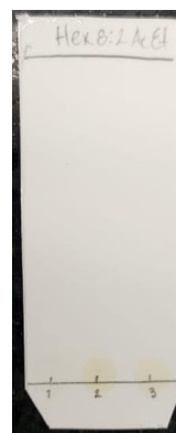
Figura 4. Resultados del revelado de la cromatografía en capa fina (TLC) (placa de la Figura 10) obtenidos con la muestra extraída de propóleos (1) en comparación con dos muestras de propóleos sin extracción previa (2) y (3). Revelado con DPPH para determinar la presencia de antioxidantes. Se observa la ausencia de sustancias antioxidantes.
