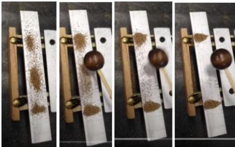
Posteriormente se marcan los nodos y se procede a perforar las teclas, tal como se muestra en la Figura 22.
