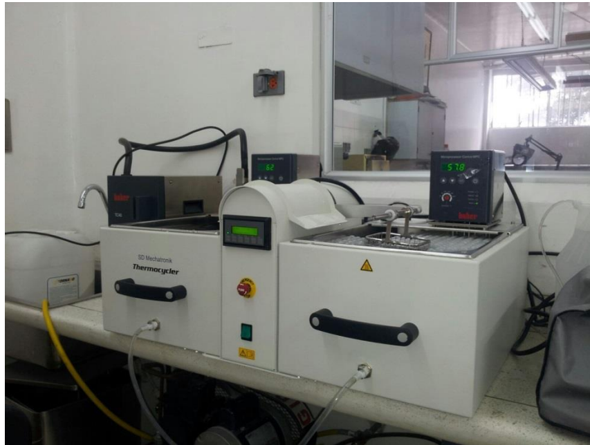
Proceso de termociclado de especímenes.
