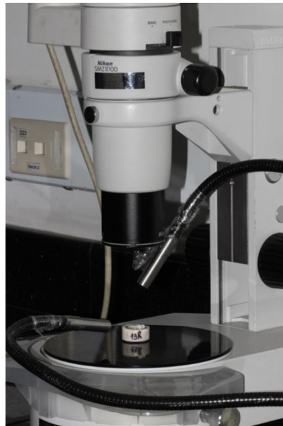
Evaluación con estereomicroscopio (Nikon® MZS 1000)
