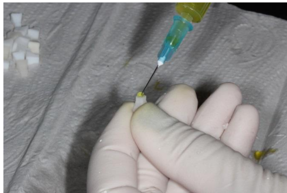
Grabado discos cerámicos con ácido fluorhídrico.
