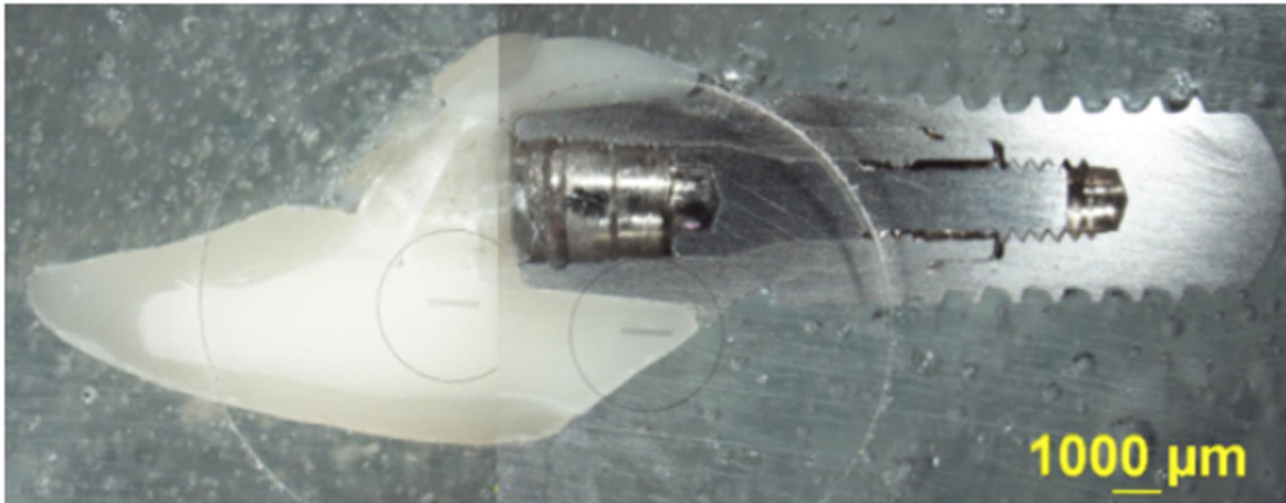
Fig 3. Imagen en estereomicroscopio (Nikon® SMZ1000) de ensamble embebido en resina acrílica transparente (Veracryl, New Stetic®) seccionado sagitalmente
