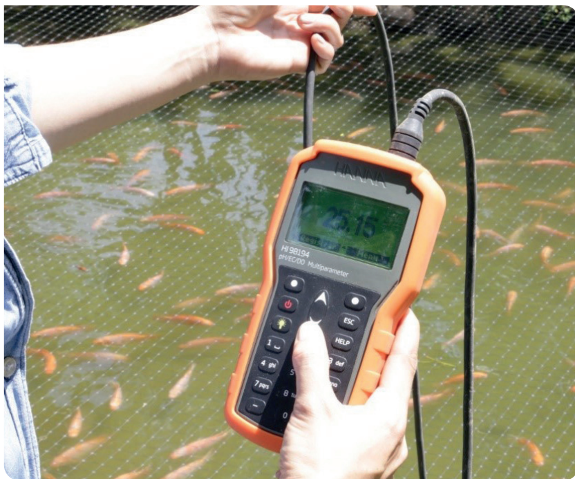
Figura 2.3. Medición de temperatura. Fuente: fotografía tomada por el autor.
